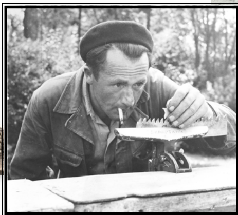
Regelmatig vijlen is belangrijk voor het onderhoud van een zaag.
